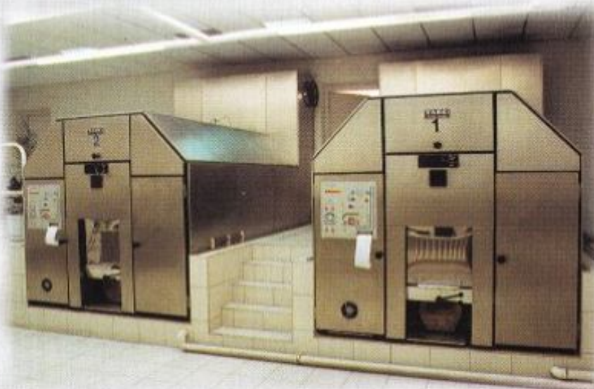
Dwa szwedzkie piece kremacyjne TABO sterowane komputerem. Jeden zasilany gazem, drugi olejem z możliwością zamiany mediów zasilających.
